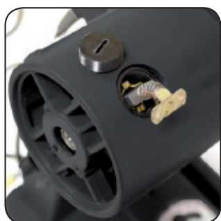
Facilité d'accès aux portes charbons. Gemakkelijke toegang tot koolborstels
